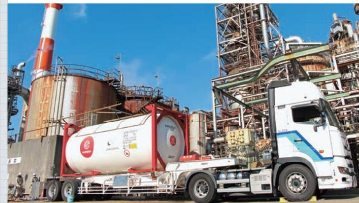
四日市製油所に搬入されたブルーアンモニアのISOタンクコンテナ
